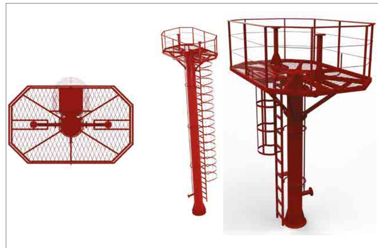
РИС. 2. ВНЕШНИЙ ВИД ВЫШКИ ПОЖАРНОЙ УНИВЕРСАЛЬНОЙ ВП-У PROFIREX ДЛЯ ДВУХ ПОЖАРНЫХ ЛАФЕТНЫХ СТВОЛОВ
