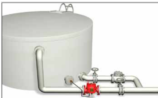
Рисунок 2. Схема установки узла DS-PC10-FP-450-82
