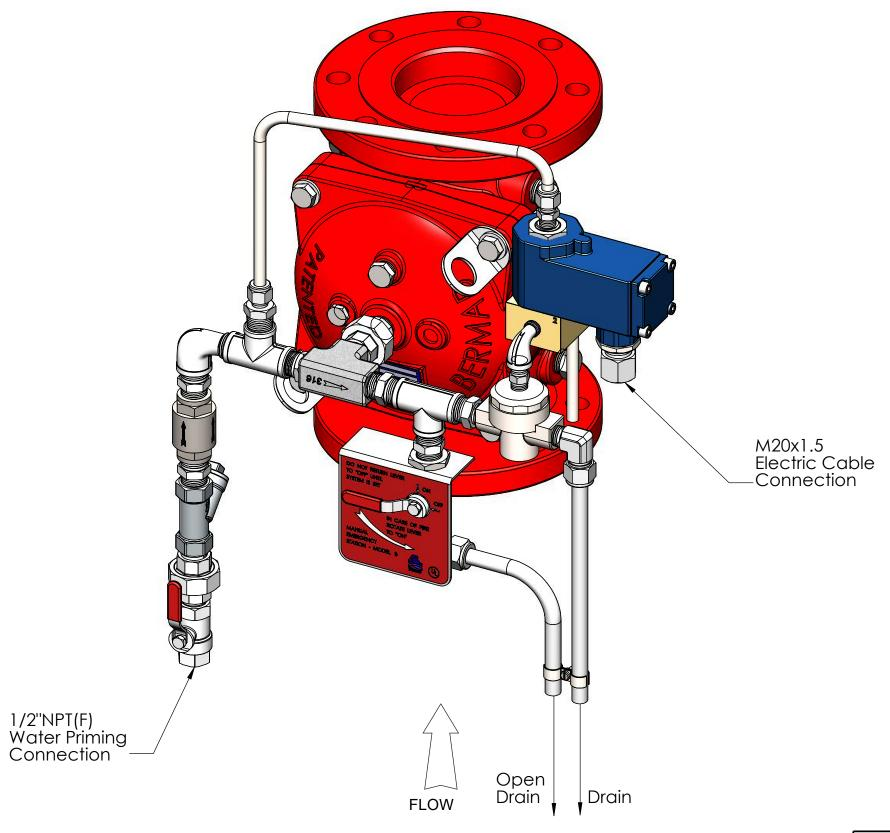
NOTE: 1. PROVIDE AMPLE CLEARANCE FOR FUTURE MAINTENANCE
